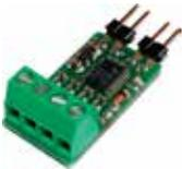
Interfaccia di adattamento per impulso, 4 canali, per sensori inerziali e contatti a corda per tapparelle.
