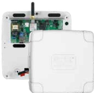
Comunicatore/modem GSM/GPRS TCP-IP
